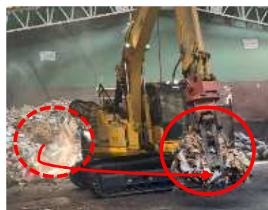
火元は重機でつかみ、 延焼しないように隔離
